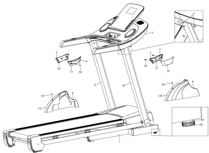
1. Закрепите кожух опорной рамы (15L/15R) на опорной раме (1) винтами (68).
