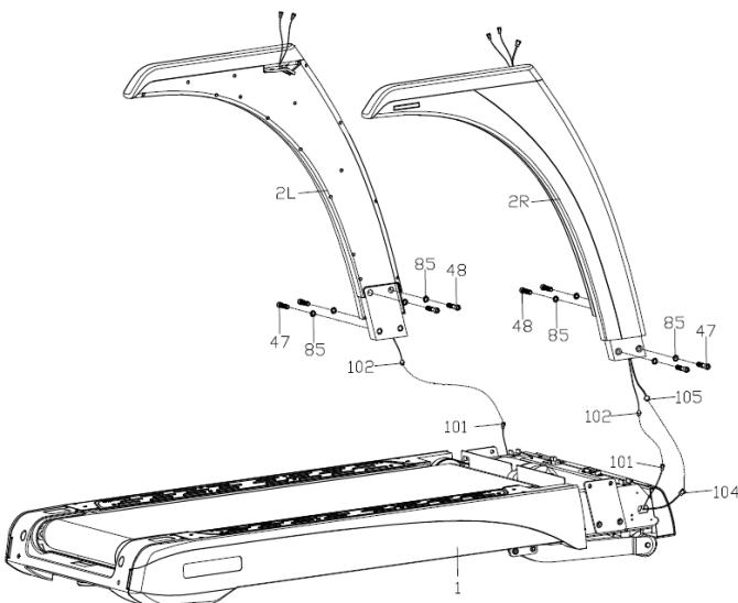
Подключите линию электропитания (101) и среднюю линию источника питания заднего индикатора (102); затем присоедините нижний провод компьютера (104) и соединительный провод компьютера (105).
